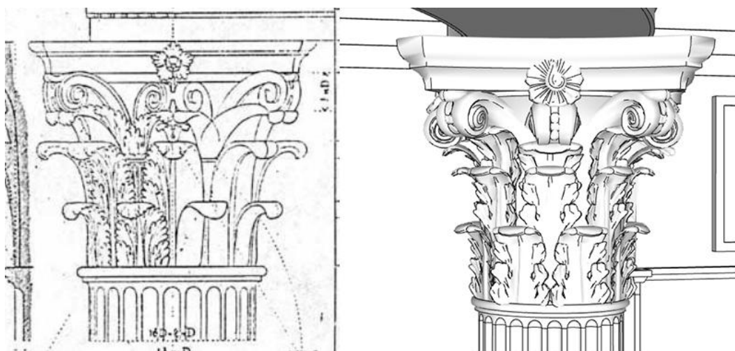
Рис. 14. Фрагмент из книги «Архитектурные формы» и модель капители коринфского ордера в полуротонде иконостаса придела Сошествия Святого Духа 16
