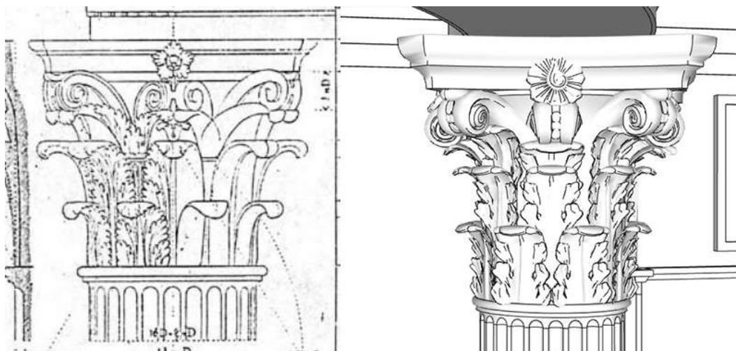
Рис. 19. Фрагмент из книги «Архитектурные формы» и модель капители коринфского ордера в полуротонде иконостаса придела Сошествия Святого Духа 178
